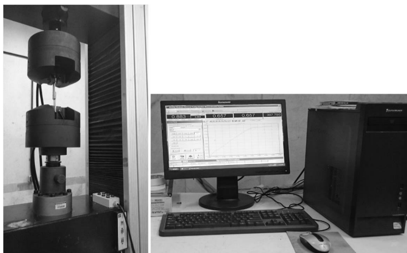
شکل ۵: دستگاه تست کشش نمونه‌های با اتصال تک لبه.
