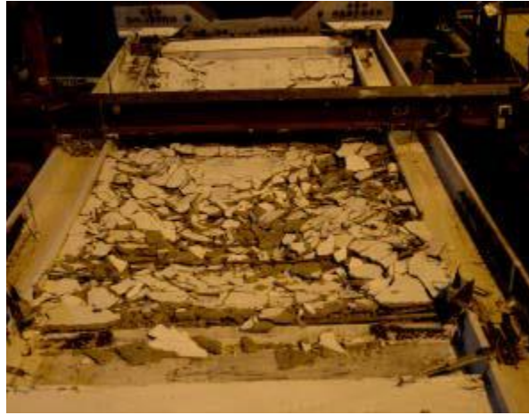
شکل ۵: نمونه آزمایشگاهی دیوار برشی مرکب بدون درز آستانه اصل و زائو[۱].
