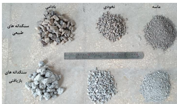
شکل ۲: سنگدانه‌های مصرفی در ابعاد و انواع مختلف.
