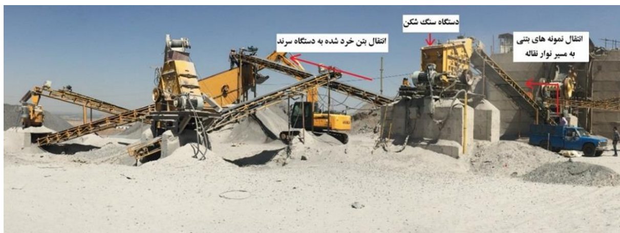
شکل ۱: مراحل تهیه و سرنند شدن سنگدانه‌های بازیافتی.
