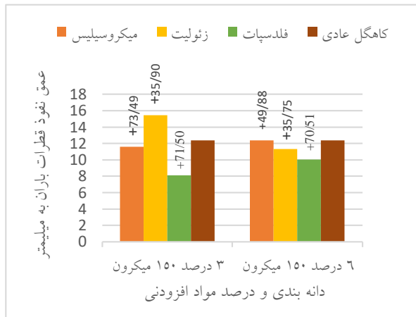
شکل ۶: نمودار تغییرات درصد هدر رفت و عمق نفوذ قطرات باران در نمونه‌های تهیه شده با مواد افزودنی تکتوسیلیکاتی ۱۵۰ میکرون در مقایسه با کاهگل معمولی.
