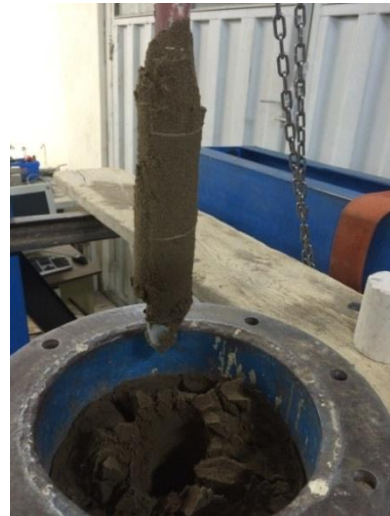
شکل ۲: انجام آزمایش بارگذاری شمع پیچی سه پره.
