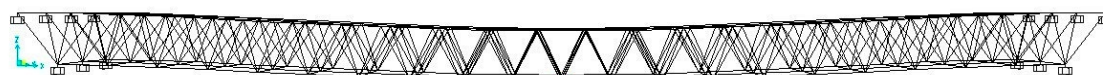
شکل ۴: خیز عرشه فضایی دو لایه با آرایش مربع روی مربع جابه‌جا شده، در اثر بارهای مرده
