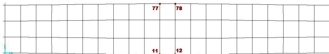
شکل ۶: محل بیشترین مقدار خیز ناشی از بارهای متحرک در عرشه فضایی دو لایه با آرایش مربع روی مربع جابه‌جا شده
