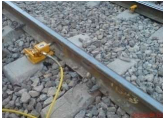
شکل ۱: آزمایش تراورس منفرد (STPT)[۲].
