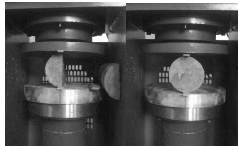
شکل ۱: نمونه و دستگاه آزمون کششی برزیلی
