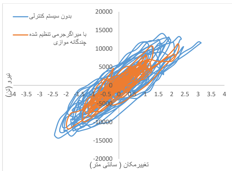
شکل ۱۹: منحنی نیرو-تغییر مکان پایه پل در دو حالت کنترل نشده و مقاوم سازی شده با میراگر MTMD موازی تحت شتابنگاشت Landers
