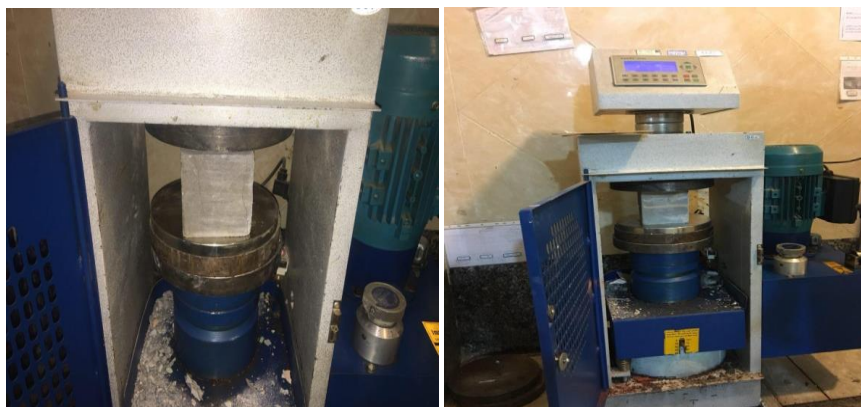
شکل ۵: چگونگی انجام آزمون مقاومت فشاری بر روی نمونه‌های RPC
