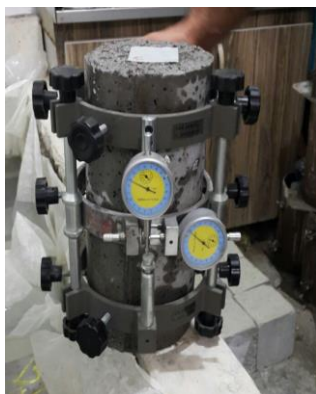
شکل ۷: نمونه استوانه‌ای RPC جهت انجام آزمایش کششی و شکست نمونه
