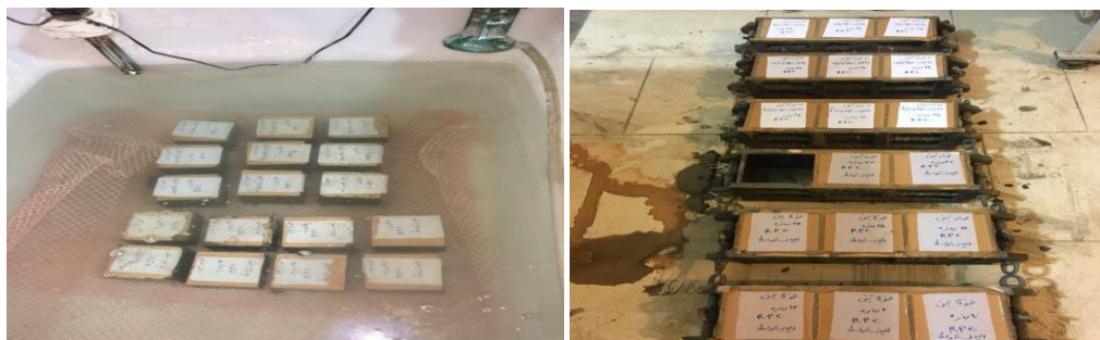
شکل ۴: (الف) نمونه‌های مختلف RPC تهیه شده جهت انجام آزمایشات، (ب) جدا کردن نمونه‌های RPC از قالب جهت عمل‌آوری مرطوب در حوضچه اشباع
