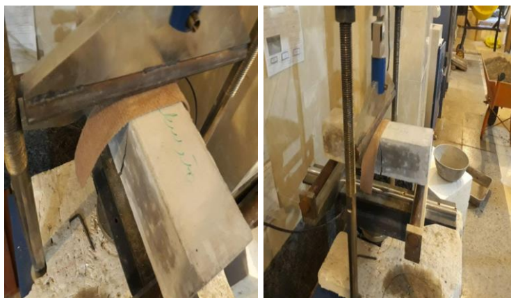
شکل ۶: نحوه انجام آزمایش خمشی بر روی تیر بتنی RPC و چگونگی شکست نمونه
