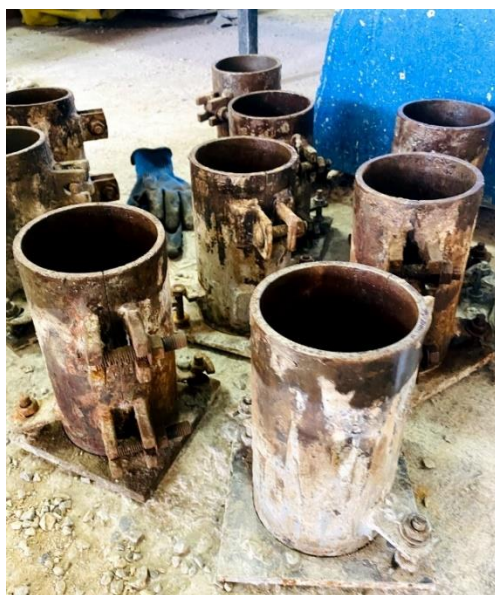
شکل ۲: قالب آماده شده برای آزمایش بیرون کشیدگی
