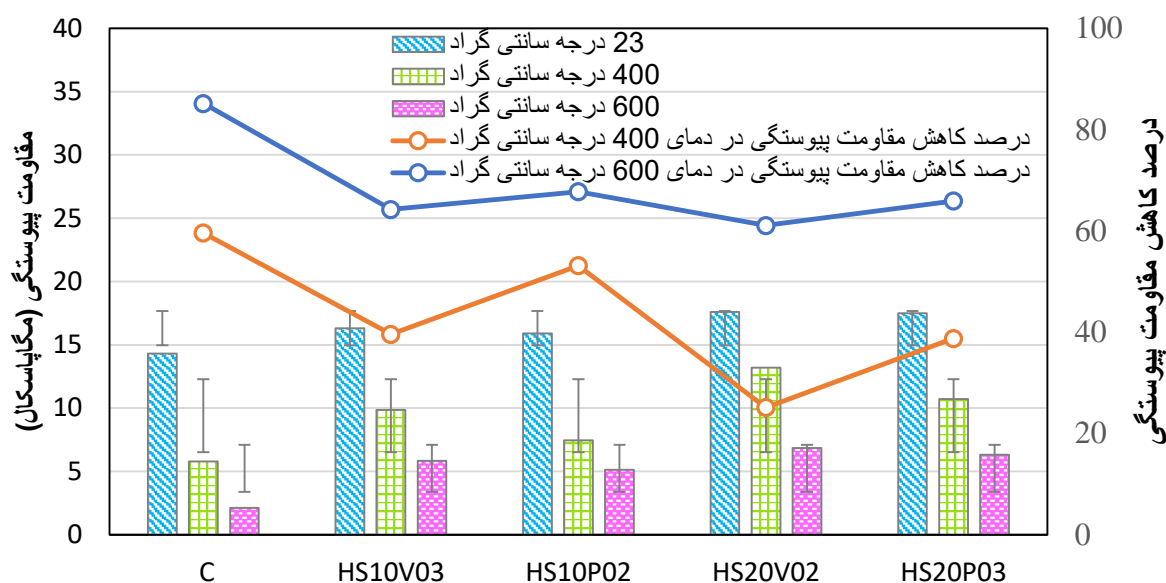
شکل ۶: نتایج آزمایش بیرون کشیدگی نمونه‌ها در دماهای ۲۳، ۴۰۰ و ۶۰۰ درجه سانتی‌گراد
