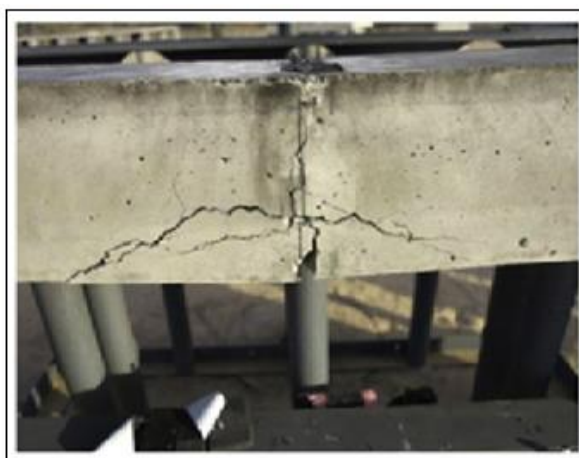
شکل ۵ : نحوه ایجاد خرابی در تیر آزمایشگاهی مورد بررسی جهت صحت سنجی مدل عددی [۹]
