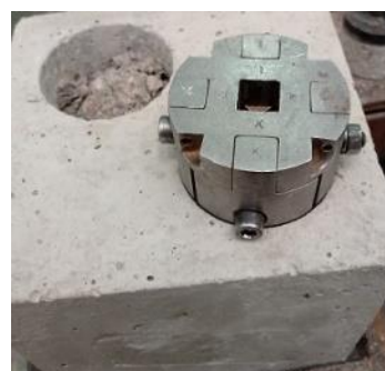
ج: قرارگیری دستگاه روی مغزه نمونه ملات
