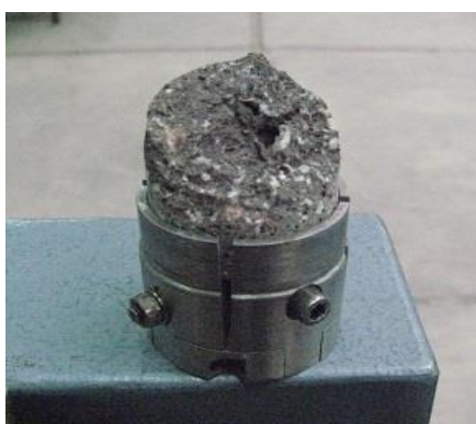
شکل ۳: مغزه شکسته شده در آزمون انتقال اصطکاک
