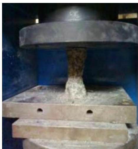
ب: مغزه‌ها در زیر جک فشاری
