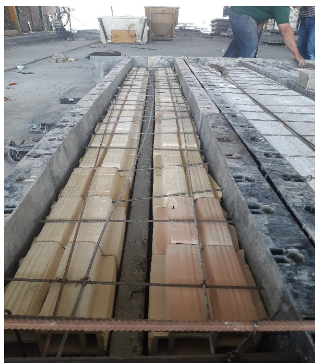
شکل ۸- نمونه تیرچه با بلوک سفال و بدون تقویت برشی
