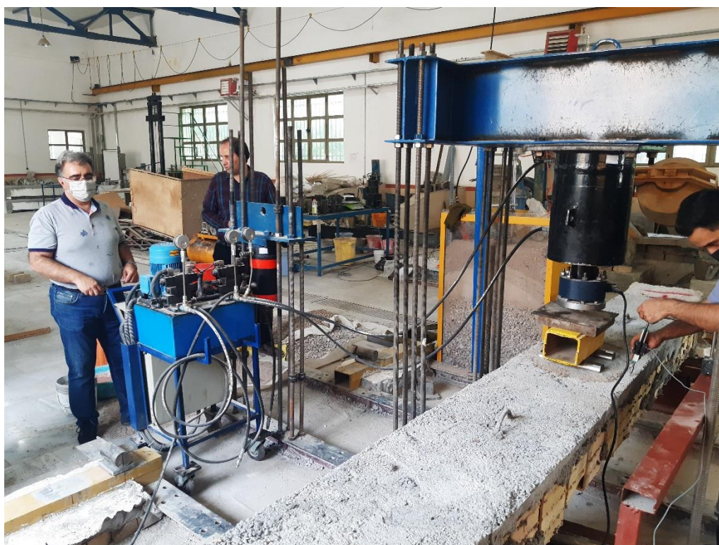
شکل ۶- بارگذاری نمونه دال تیرچه بلوک
