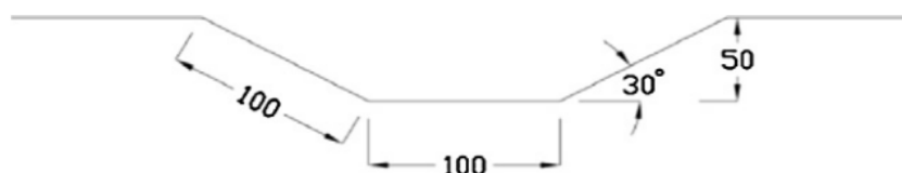
شکل ۳: مشخصات هندسی ورق موجدار دوزنقه‌ای (mm) [۹]
