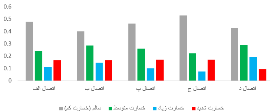
شکل ۱۱: خسارات وارده به اتصالات شکل ۱۰ تحت بار لرزه ای لوما پریتا.
