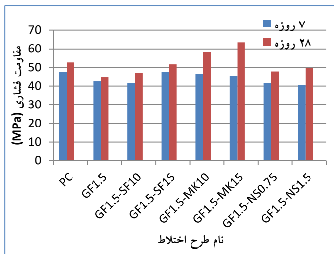
شکل ۲: تأثیر نوع و میزان مواد پوزولانی بر روی مقاومت فشاری بتن مسلح شده با ۱/۵٪ الیاف بازیافتی و ضایعات شیشه بازیافتی
