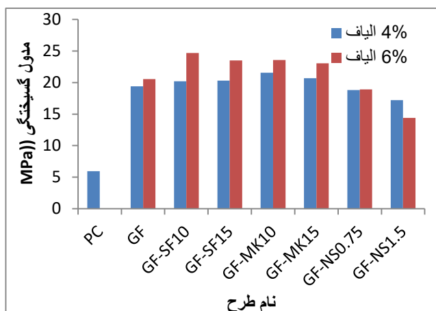
شکل ۱۷: تأثیر میزان الیاف بازیافتی و ضایعات شیشه بر روی مدول گسیختگی ۹۰ روزه ی بتن مسلح شده به الیاف بازیافتی و ضایعات شیشه در روش اسپری
