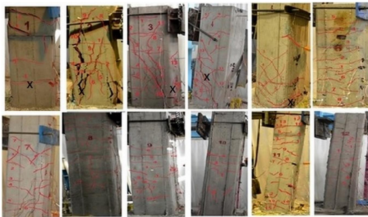
شکل ۱۲: الگوهای ترک خوردگی نمونه‌های تحت آزمایش.
