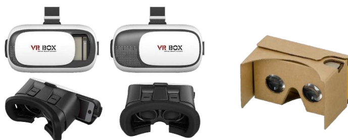
شکل ۱: انواع مختلف عینک‌های واقعیت مجازی. ردیف بالا: هدست، ردیف پایین: کاردبورد.
