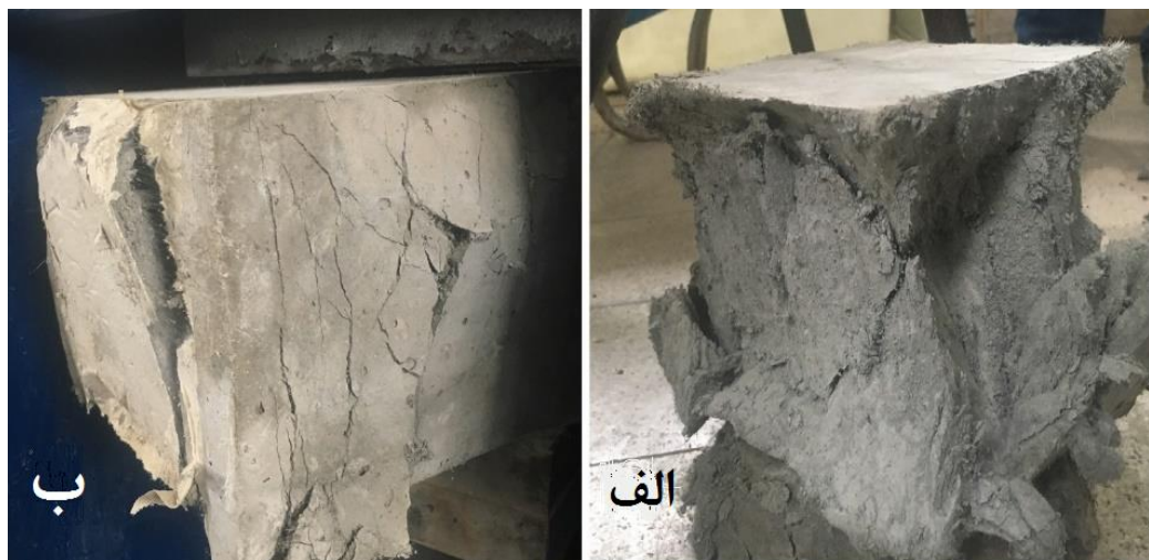
شکل ۳- آزمایش مقاومت فشاری نمونه‌ها . (الف) ECC (ب) CNF-ECC
