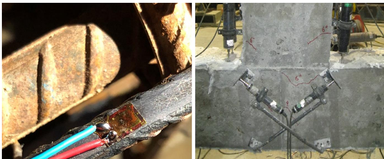
شکل ۶- نحوه نصب LVDT در محل چشمه اتصال در پشت نمونه و نحوه اتصال استرین گیج ها به آرماتورها.
