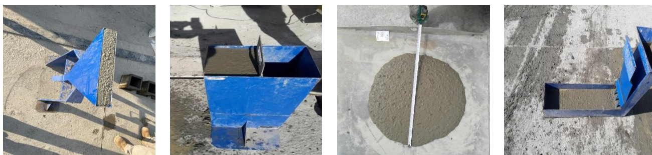
شکل ۴: آزمایش‌های بتن خودتراکم تازه برای تأمین کارایی مطابق با محدوده EFNARC
