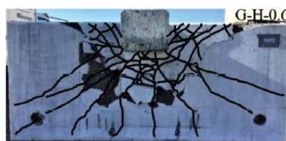
(الف) گسترش ترک‌های وجه پایین دال در نمونه‌ی آزمایشگاهی G-H-0.6 [۲۱]
