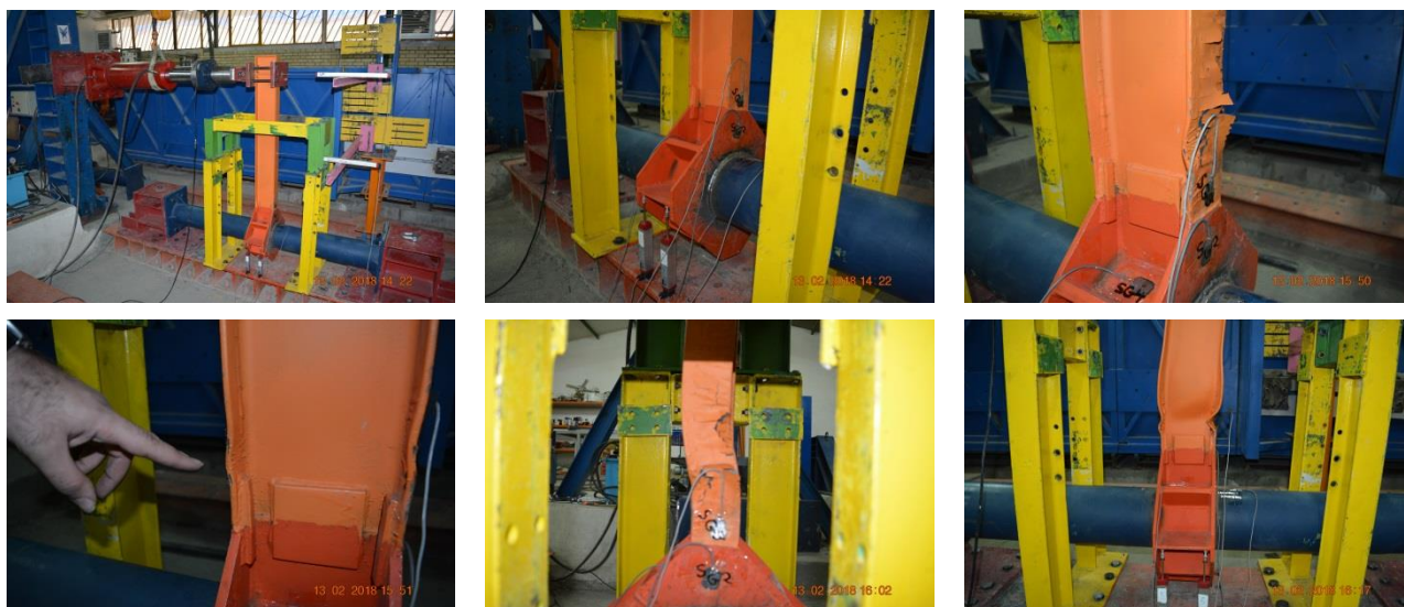
شکل ۶: نمونه قاب C1 در مراحل مختلف بارگذاری و تغییر شکل های پلاستیک تیر.
