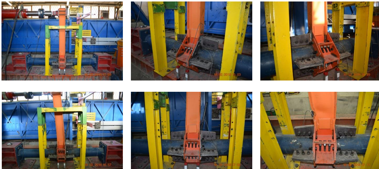
شکل ۱۰: نمونه قاب C3 در مراحل مختلف بارگذاری و تغییر شکل های پلاستیک تیر.
