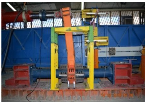
شکل ۸: نمونه قاب C2 در مراحل مختلف بارگذاری و تغییر شکل های پلاستیک تیر.
