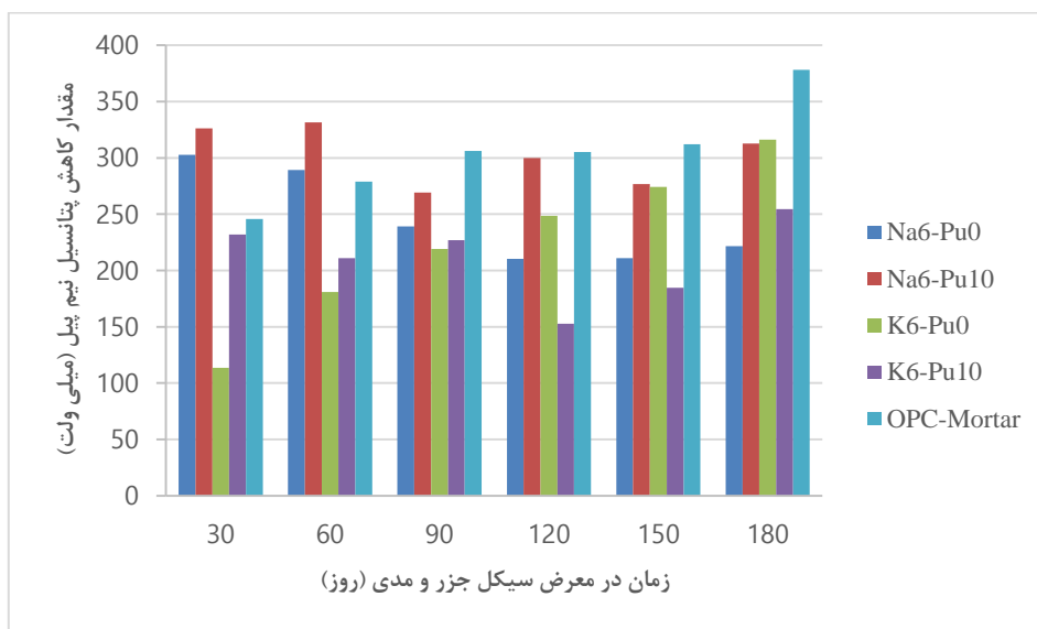
شکل ۱۳: مقدار کاهش پتانسیل خوردگی آزمون‌های ملات قلیافعال و سیمان پرتلندی شاهد در معرض سیکل جزر و مدی
