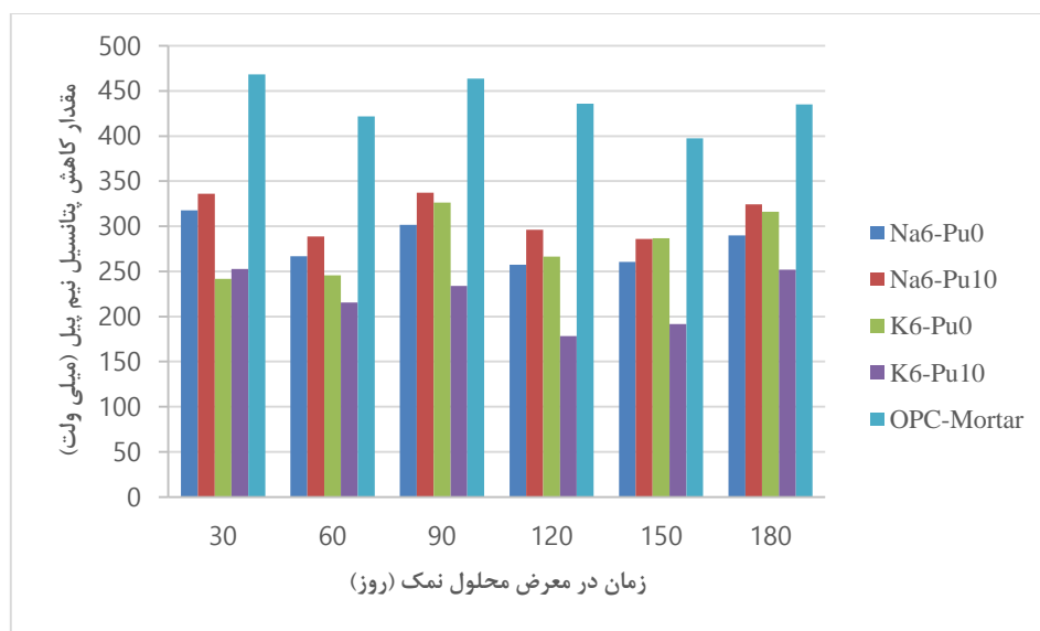
شکل ۱۱: مقدار کاهش پتانسیل خوردگی آزمونه‌های ملات قلیافعال و سیمان پرتلندی شاهد در محیط مغروق
