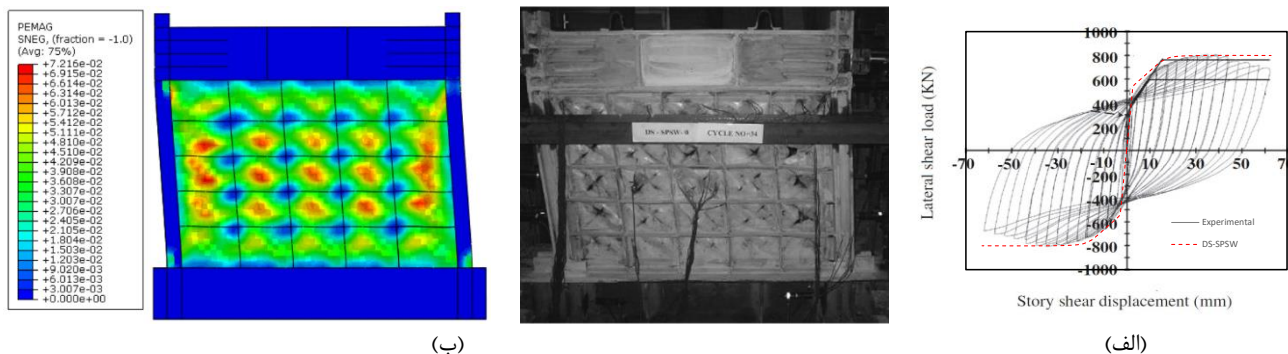
شکل ۸: الف) مقایسه منحنی بار-جابجایی نمونه آزمایشگاهی و مدل عددی، ب) مقایسه حالت خرابی نمونه آزمایشگاهی و مدل عددی.
