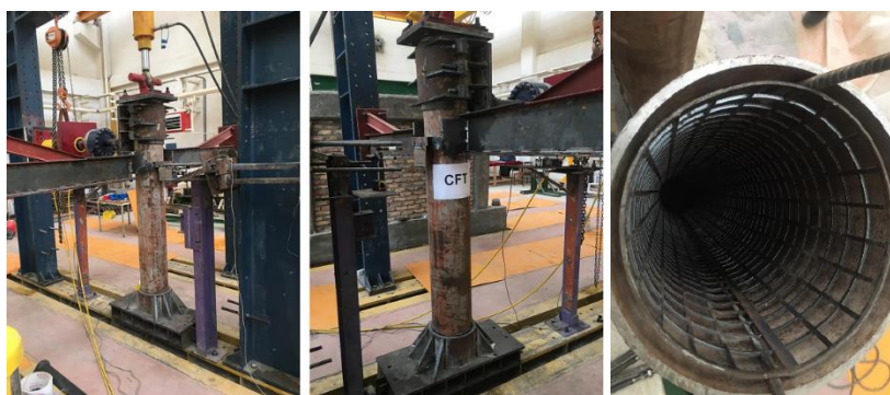
شکل ۴: نمونه‌های آزمایشگاهی تحت اثر بارگذاری همزمان محوری و لرزه‌ای
