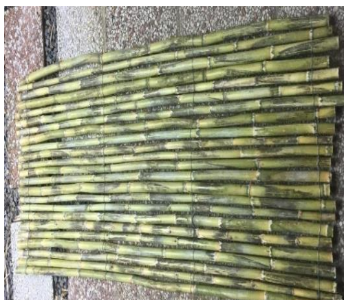
شکل ۵: نی های بافته شده برای پنل دیواری
