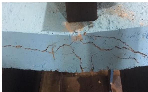
شکل ۲۱: شکست پنل با حضور نی و توری مشبک آهنی
