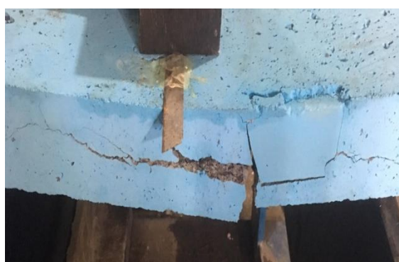
شکل ۲۰: شکست پنل با حضور نی
