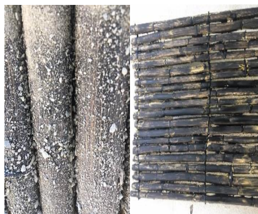
شکل ۴: قیرکاری و ماسه پاشی نی ها
