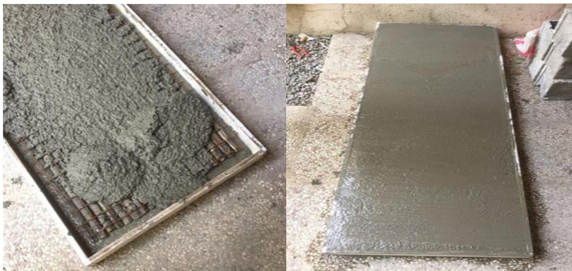
شکل ۶: پنل ساخته شده با نی و توری مشبک
