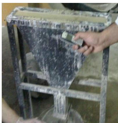
الف) آزمایش قیف V شکل
