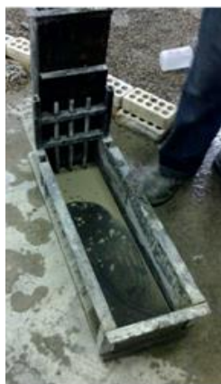
ب) آزمایش جعبه L شکل
