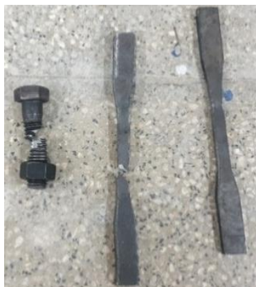
شکل ۵: الگوی خرابی نمونه‌های ورق و پیچ.
