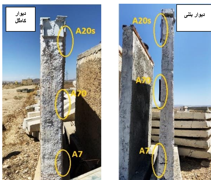
شکل ۱۱: محل قرارگیری و نصب گوشی‌های هوشمند جهت برداشت شتاب سازه
