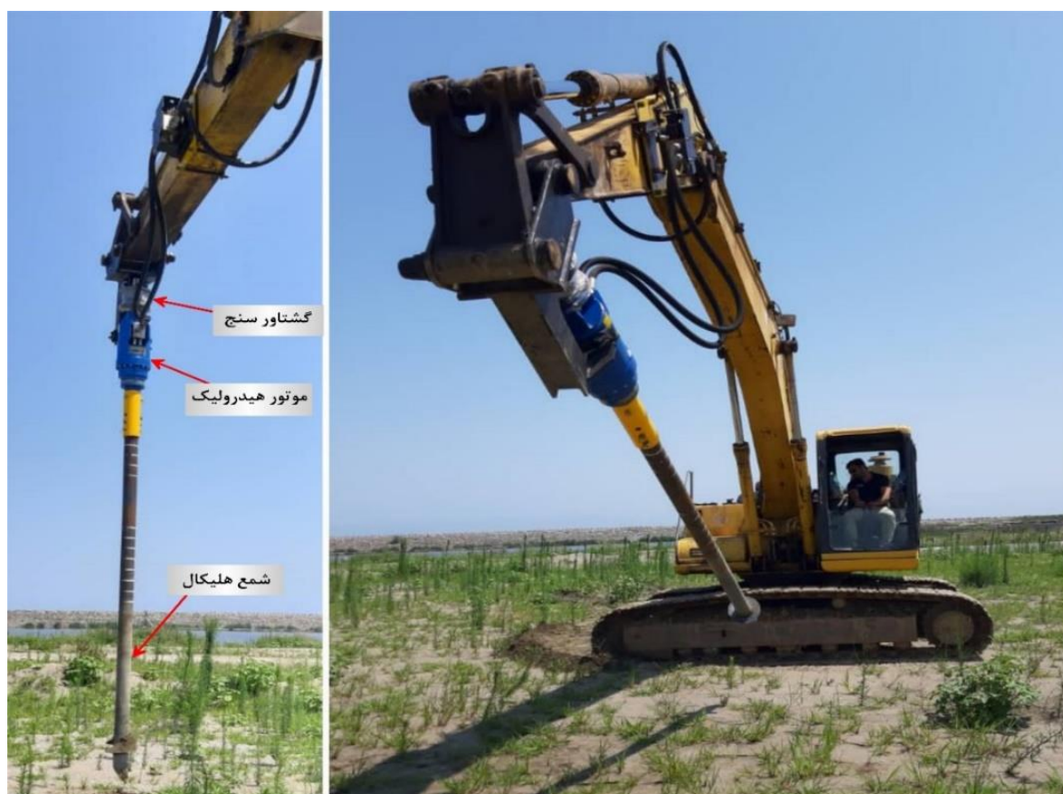
شکل ۵ تجهیزات هیدرولیکی مورد نیاز جهت نصب شمع
