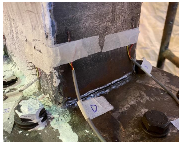
شکل ۲۱: تغییر شکل ها و ترک های بوجود آمده بعد از اعمال بارگذاری در لینک شماره ۱ و ۲ (سمت راست لینک ۱ و سمت چپ لینک ۲)
