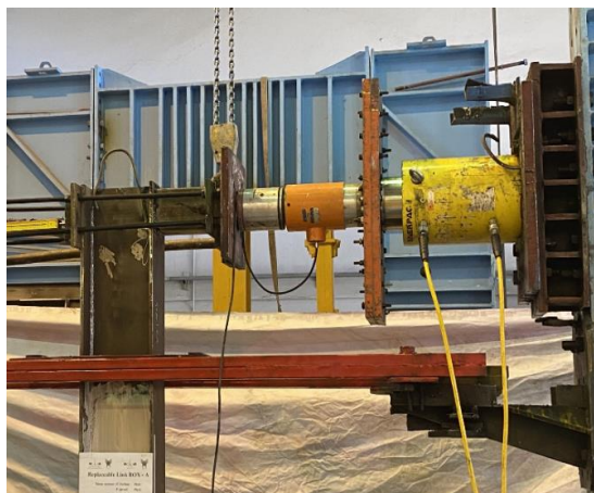
شکل ۱۲: نحوه اتصال ستون و جک به Reaction Frame.
