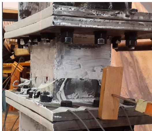
شکل ۲۱: تغییر شکل ها و ترک های بوجود آمده بعد از اعمال بارگذاری در لینک شماره ۱ و ۲ (سمت راست لینک ۱ و سمت چپ لینک ۲)
