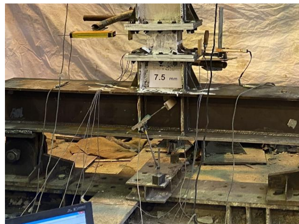
شکل ۱۲: نحوه اتصال ستون و جک به Reaction Frame.
