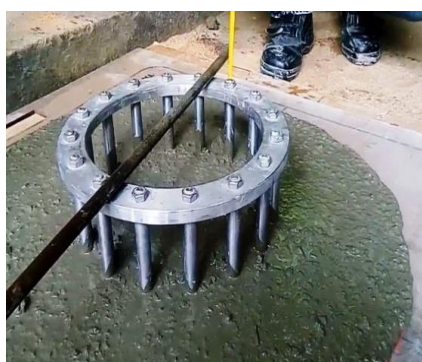
شکل ۳: آزمایش حلقه J
