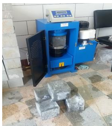
شکل ۷: آزمایش مقاومت فشاری
