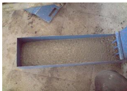
شکل ۵: آزمایش جعبه L
