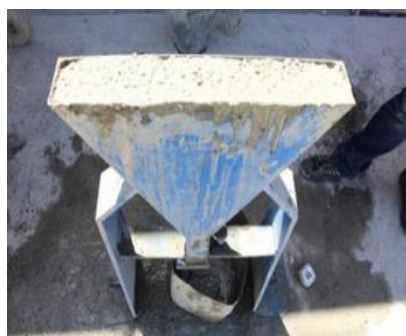
شکل ۴: آزمایش قیف V
