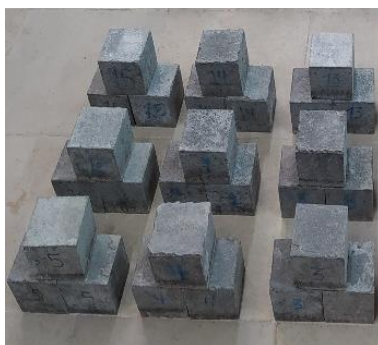
شکل ۷: نمونه های مورد استفاده در آزمایش مقاومت فشاری.
