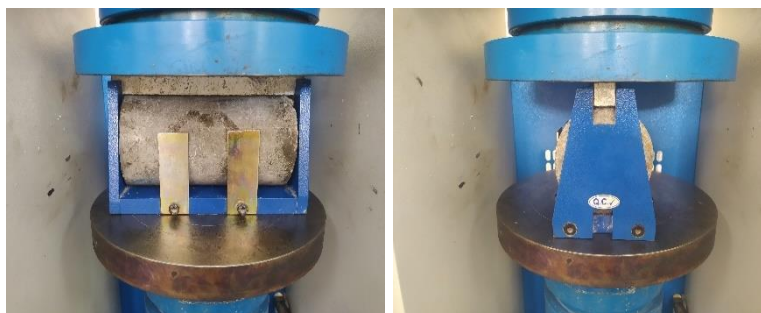
شکل ۹: انجام آزمایش مقاومت کششی.
