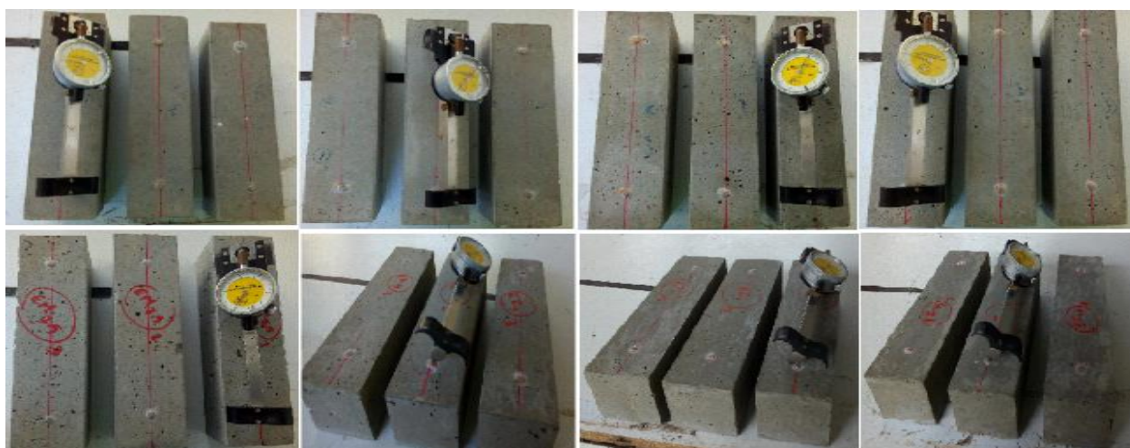
شکل ۱- نمونه های جمع شدگی که توسط کرنش سنج مکانیکی قرائت می شود
