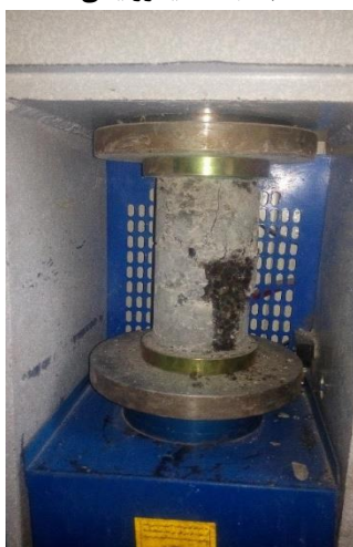
د) نحوه‌ی شکست نمونه زیر جک
