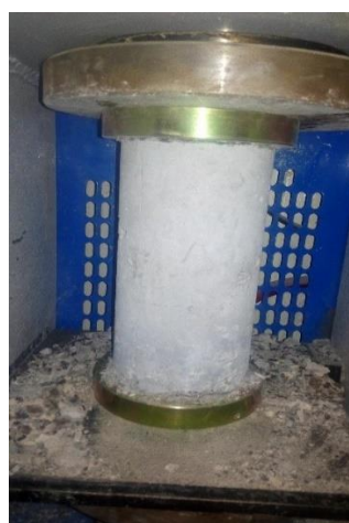
ج) نحوه‌ی قرارگیری نمونه در زیر جک
