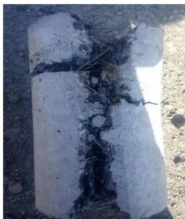
(ج) عملکرد الیاف پس از انجام آزمایش شکل ۱۱: آزمایش مقاومت کششی
