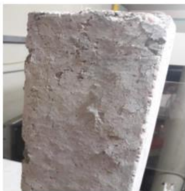
شکل ۵: تغییر شکل ظاهری و پوسته شدن نمونه
