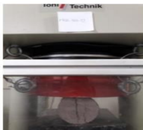
(الف) نحوه قرارگیری نمونه زیر جک
