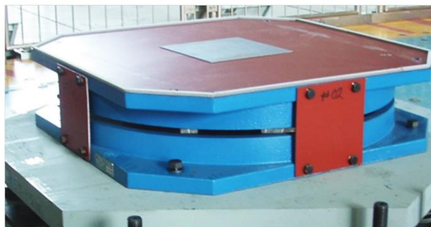
شکل ۳: الف) پیکربندی یک جداساز پاندولی اصطکاکی، ب) نمونه ای از یک سیستم پاندول اصطکاکی [۱۲].
