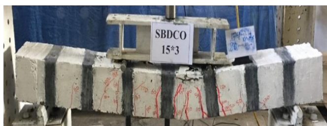
شکل ۴۰- نمایش خیز تیر بتن آرمه SBDCO15-3
