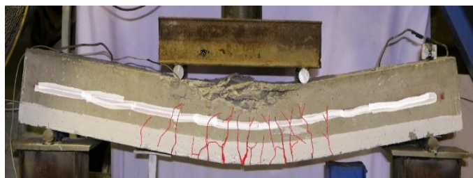
شکل ۱۹- توزیع تنش در تیر بتن آرمه BDCO15-3
