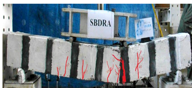
شکل ۳۴- نمایش خیز تیر بتن آرمه SBDRA
