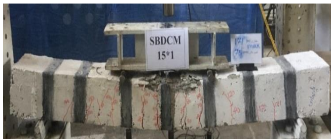
شکل ۴۲- نمایش رشد ترک در تیر بتن آرمه SBDCM15-1
