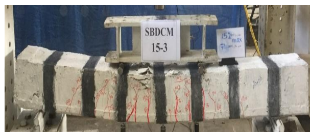
شکل ۳۶- نمایش رشد ترک در تیر بتن آرمه SBDRCM15-3
