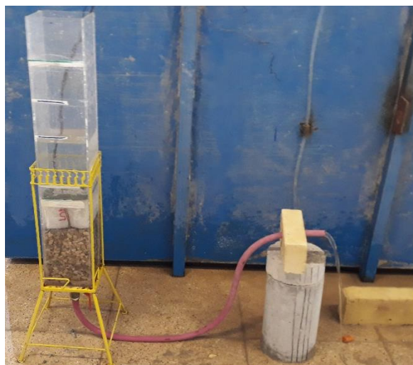
شکل ۵: دستگاه اندازه‌گیری نفوذپذیری نمونه‌های بتن متخلخل
