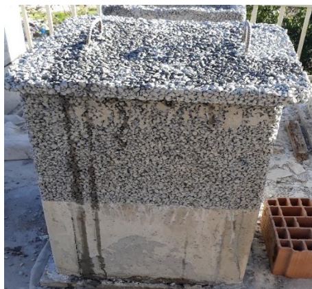
شکل ۹: مخزن با جداره پائینی بتن و بالایی بتن متخلخل
