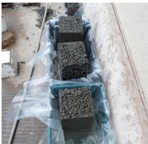
شکل ۷: نمونه‌های مکعبی بتن متخلخل
