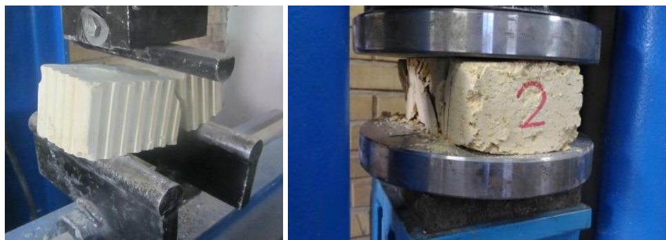
شکل ۵: آزمایش مقاومت فشاری و مقاومت خمشی آجر
