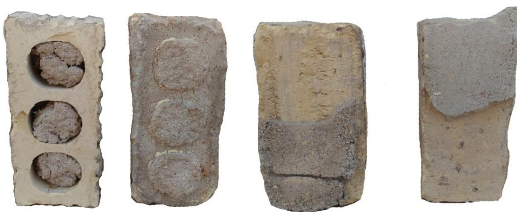
شکل ۱۹: شکست اتصال آجر و ملات نمونه‌های منشور آجرکار در آزمون چسبندگی برشی
