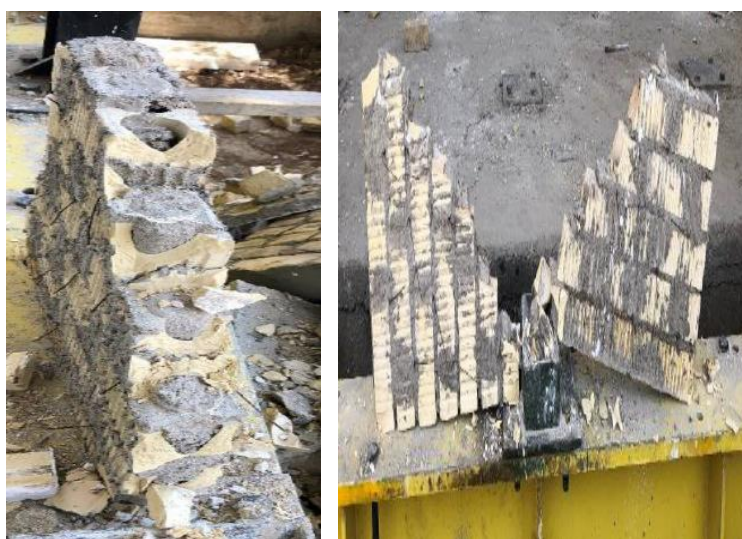
شکل ۱۴: شکست قطری پانل‌های آجر سوراخ‌دار
