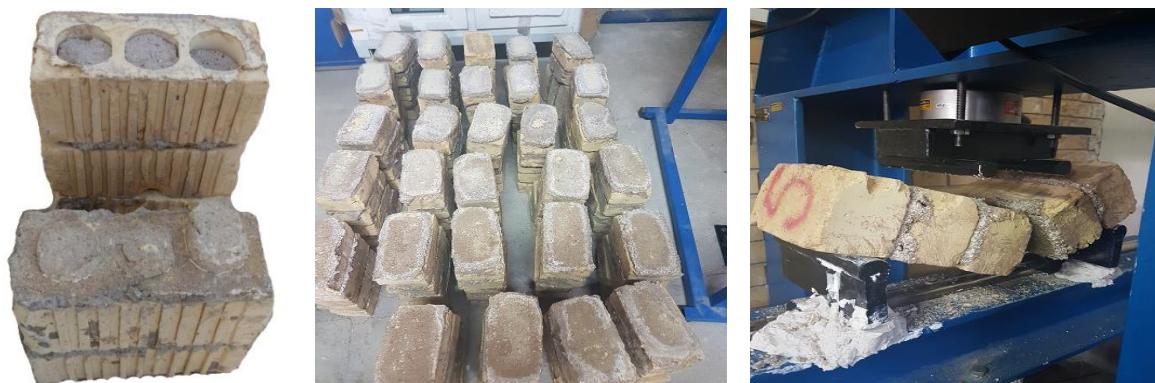
شکل ۱۷: جزییات آزمایش و شکست اتصال آجر و ملات نمونه‌های منشور آجرکار در آزمون کشش خمشی
