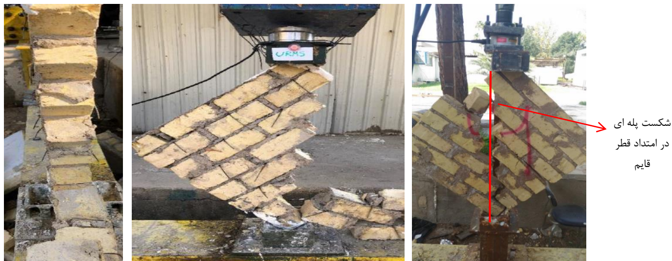
شکل ۱۳: شکست قطری پانل‌های آجر توپر
