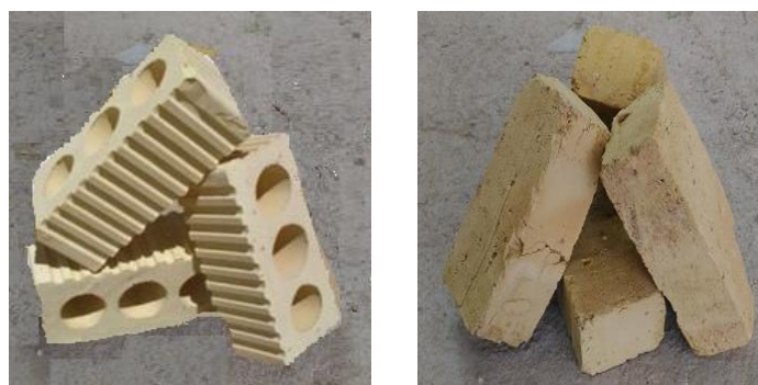
شکل ۴: آجر توپر (گری) و سوراخ‌دار (سه‌گل) مورد استفاده در ساخت منشورهای آجرکار
