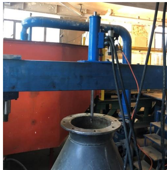
شکل ۵: سیستم بارگذاری دستگاه FCV دانشگاه امیرکبیر
