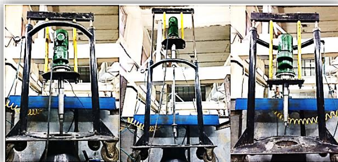
شکل ۹: قرارگیری شمع‌های پیچشی پره‌ای در دستگاه FCV (با استفاده از تورک موتور)
