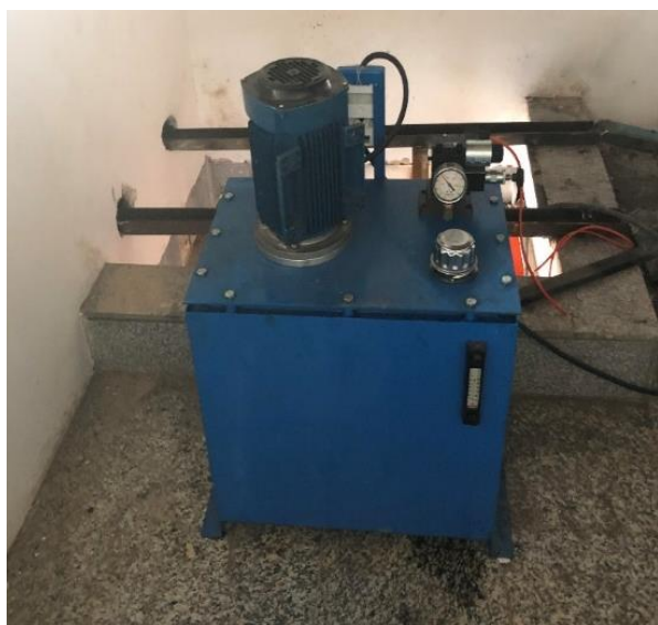
شکل ۵: سیستم بارگذاری دستگاه FCV دانشگاه امیرکبیر
