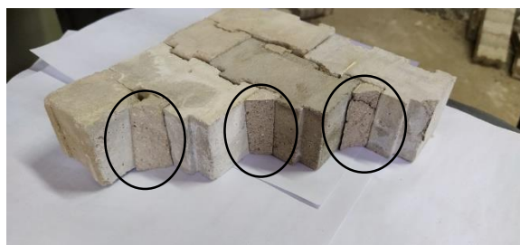
شکل ۱۵: شکست نمونه‌های قطری بدون چسب
