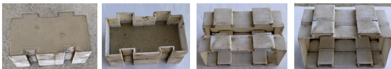
شکل ۶: قالب‌های ساخته شده توسط چاپگر سه بعدی و ساخت بلوک در قالب
