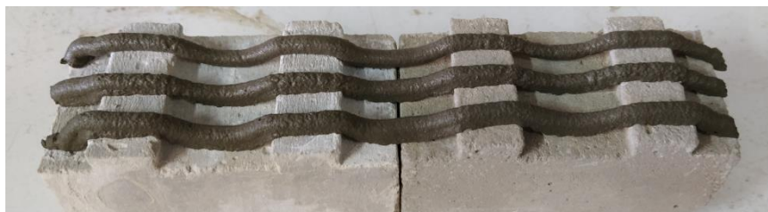
شکل ۲: نحوه استفاده از چسب در منشورهای ساخته شده با چسب
