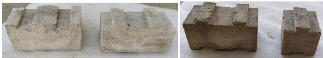
شکل ۴: انواع بلوک‌های در هم قفل شونده جهت ساخت دیوار بنایی (از راست به چپ: نیم بلوک، بلوک کامل، بلوک بالایی و بلوک پایینی)
