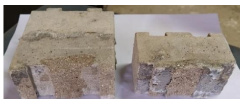
شکل ۲۱: شکست نمونه‌های آزمایش مقاومت برش مستقیم برون صفحه با چسب
