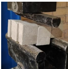
شکل ۱۹: مقاومت برش خارج از صفحه بلوک‌ها در حالت خشکه چینی
