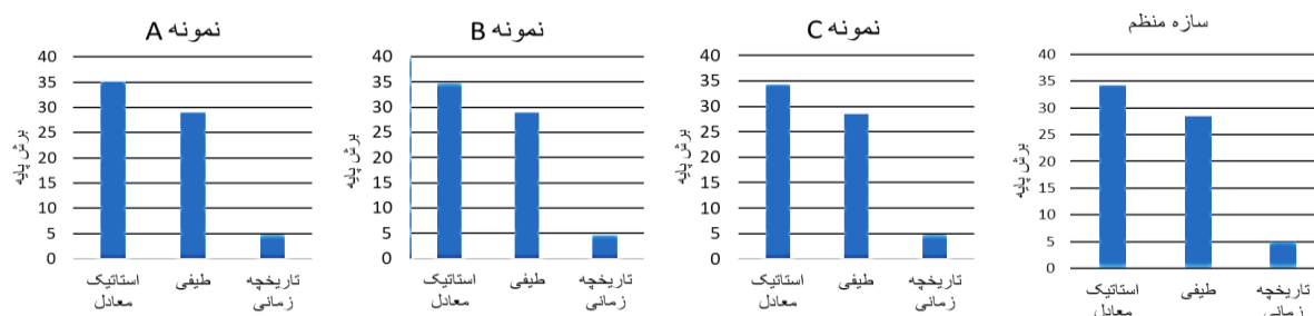
شکل ۳۰: مقایسه تحلیل‌ها در برش پایه مدل منظم و مدل‌های دارای نامنظمی قطع سیستم باربر جانبی (به تن)
