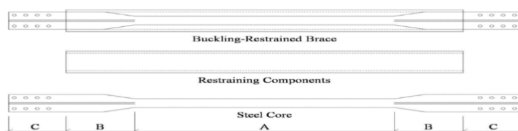
شکل ۱: اجزای مهاربند کمانش‌تاب [۹].
