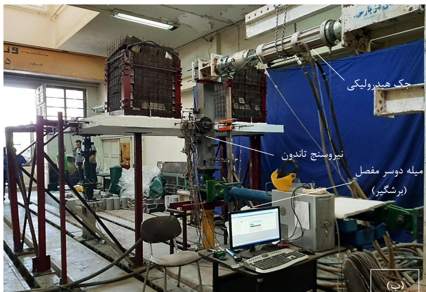
شکل ۷: برپایش آزمایش و نمونه آزمایشگاهی به همراه بارهای ثقلی: الف) نمای جلو، ب) نمای پشت
