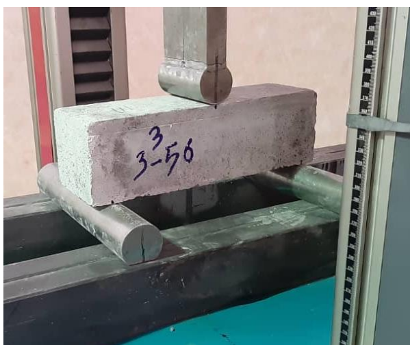
شکل ۶: نمونه منشوری تحت آزمایش خمش سه نقطه‌ای
