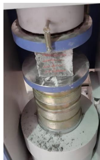
شکل ۵: نمونه مکعبی تحت آزمایش مقاومت فشاری
