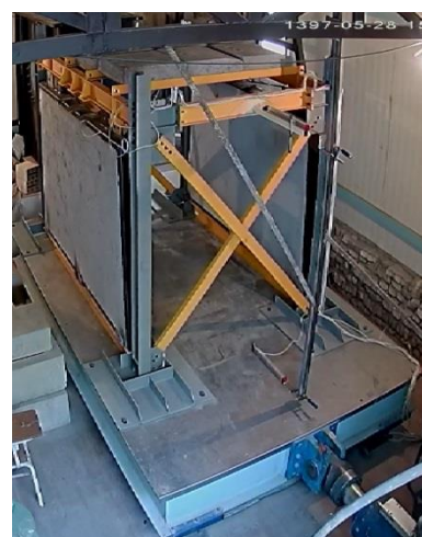
شکل ۱۵: نصب مدل آزمایشگاهی روی میز لرزه
