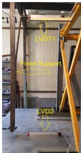
شکل ۸: نصب جابه‌جایی سنجه‌ها روی مدل آزمایشگاهی.
