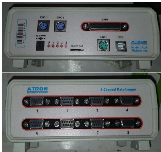
شکل ۹: دستگاه ثبت اطلاعات ۱۶ کانال ساخت شرکت آترون
