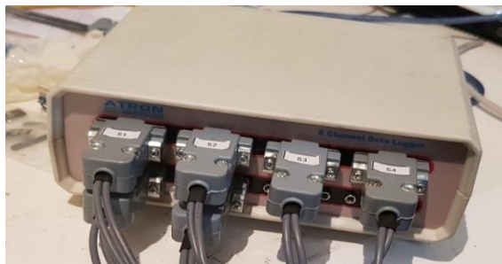
شکل ۱۱: اتصال کابل‌ها به درگاه‌های ورودی دستگاه ثبت اطلاعات
