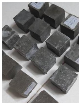
الف) نمونه های مکعبی ملات (ب) نمونه های بتنی تقویت شده با CFRP با و بدون پوشش محافظ شکل ۴: نمونه های مورد آزمایش
