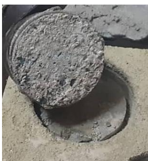
ج) نمونه با پوشش محافظ آبند پایه اپوکسی، گسیختگی در سطح بالایی بتن و ماتریس
