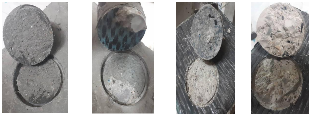
الف) نمونه بدون پوشش محافظ، گسیختگی در بتن بستر (مود A) ب) نمونه بدون پوشش محافظ، گسیختگی در سطح بالایی بتن و ماتریس (مود A/B) ج) نمونه با پوشش محافظ الیافی، ترکیبی از گسیختگی بتن بستر و ناحیه چسب (مود B) د) نمونه با پوشش محافظ الیافی، گسیختگی در محل اتصال پوشش محافظ به CFRP (مود F)
