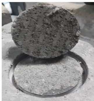
ج) نمونه با پوشش محافظ ملات الیافی حاوی ماده هوازا، گسیختگی در مرز اتصال پوشش محافظ به CFRP
