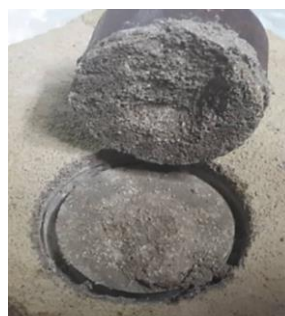
ب) نمونه با پوشش محافظ ملات ماسه سیمان حاوی چسب، گسیختگی مرز اتصال پوشش محافظ به CFRP
