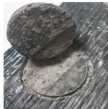
الف) نمونه بدون پوشش محافظ، گسیختگی در محل اتصال ورق CFRP به چسب
