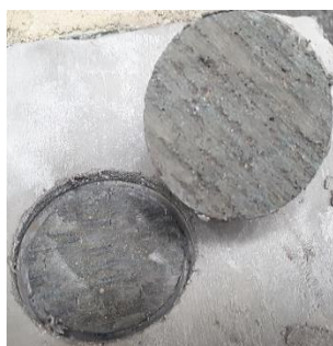
د) نمونه با پوشش محافظ آبند پایه اپوکسی، گسیختگی مرز اتصال پوشش محافظ به CFRP
