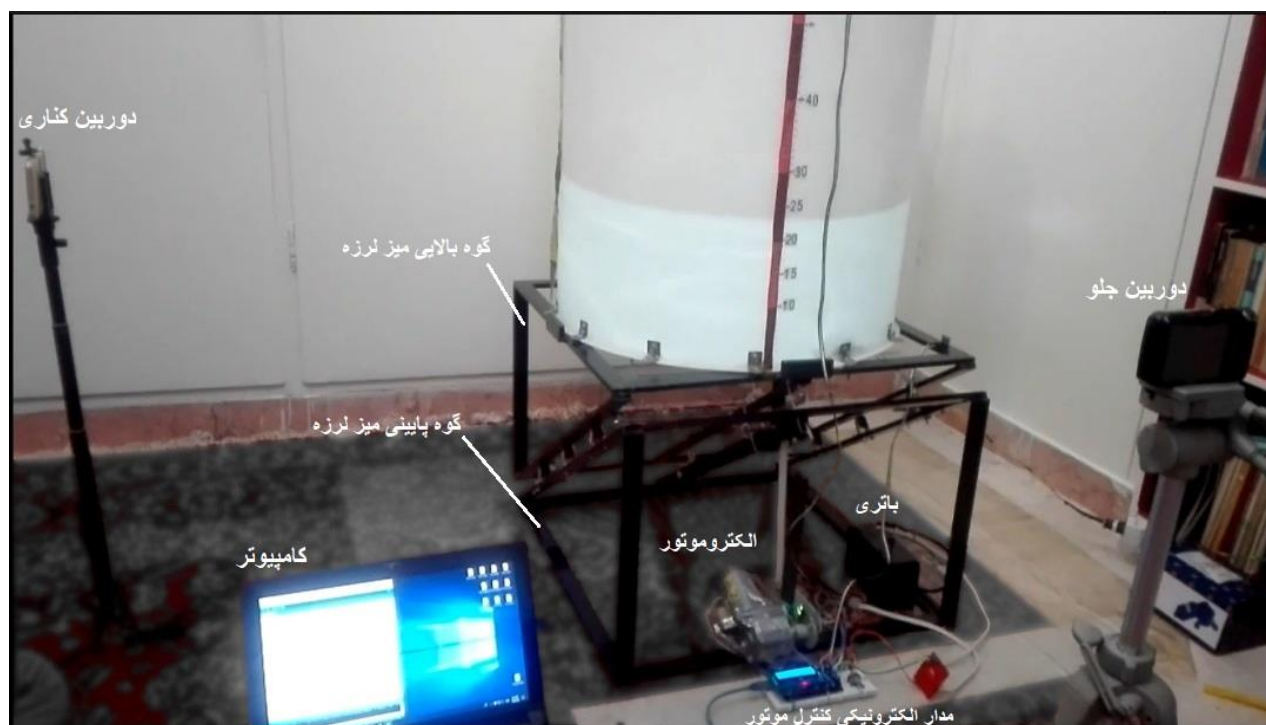
شکل ۱: نمایی از مخزن بر روی سامانه ابتکاری حرکات نوسانی
