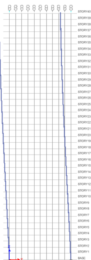
شکل ۷: مود اول ارتعاش سیستم لوله‌ای ۴۰ طبقه با زاویه هرمی ۰ درجه المان محدود.
